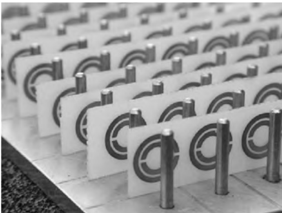
Рис. 4. Комбинация структур с отрицательной диэлектрической и отрицательной магнитной проницаемостями (экспериментальная реализация).
